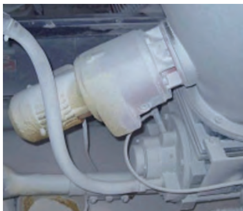
Figura 17 - La acumulación de polvo debe ser evitada. Un procedimiento de limpieza adecuado puede evitar la clasificación de la zona.
