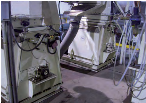
Figura 32 - Molinos de martillos sin protección.
