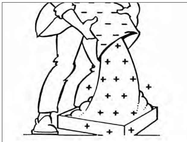
Figura 6 - En los procesos de ensacado, trasvase, transporte, etc. de polvos inflamables se pueden formar ATEX.
